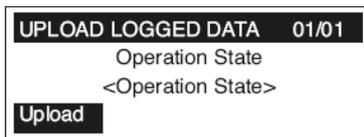
Теперь перейдите на метку Upload to Copy Card (Загрузить на Карточку копирования) и нажмите OK для запуска операции загрузки сохраненного файла данных на карточку. Название создаваемого файла задается параметром 459 - rECF (°).(см. описание параметров). Данный файл имеет расширение REC. Появится сообщение о Рабочем состоянии, а при ошибке выполнения одно из сообщений.
