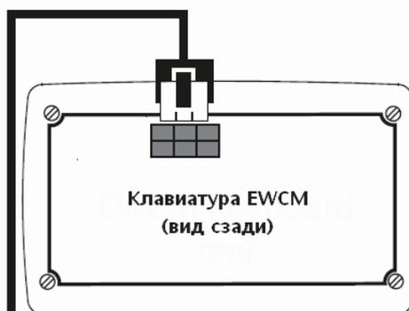
Для подключения КЛАВИАТУРЫ к БАЗЕ используйте поставляемый 6-ти жильный кабель длиной 3м. Он соответствует максимальной длине соединения. Прокладывайте этот кабель отдельно от силовых кабелей системы во избежание действия помех.
