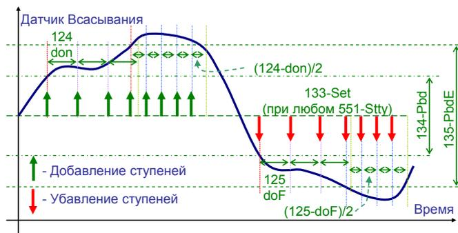
Рассматриваются 2 мертвые зоны: 134 – Pbd и 135-PbdE. Зона 135 – PbdE обычно шире чем 134 – Pbd и выход за большую зону сокращает интервал добавление и убавление ресурсов в 2 раза.
