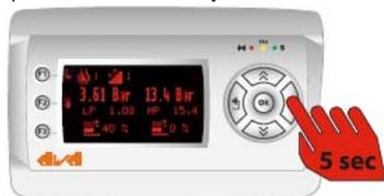
Меню отображает значения давления и температуры датчиков.
