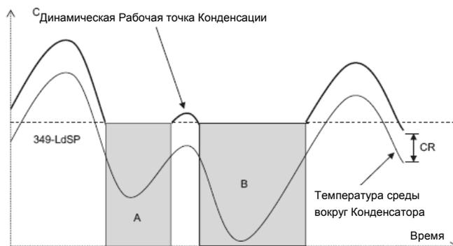
Для предотвращения возврата жидкости в конденсатор нужно контролировать и переохлаждение (UCtemp), которое рассчитывается с использованием датчика переохлаждения (перед жидкостным ресивером) и датчиком нагнетания:
